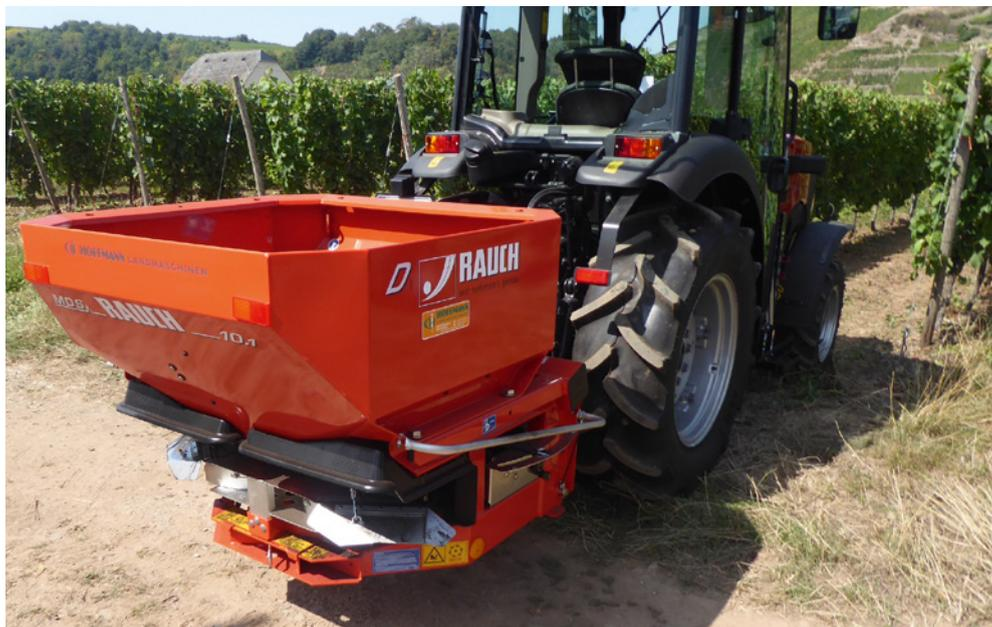
Bild 3: Mit dem Weinbaudüngerstreuer MDS der Firma Rauch Landmaschinenfabrik ist eine zielgenaue Unterstockablage möglich
